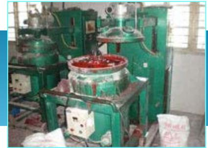
Готовый компаунд из миксеров подается под давлением в предварительно разогретые пресс-формы, установленные на специальных литьевых прессах.
