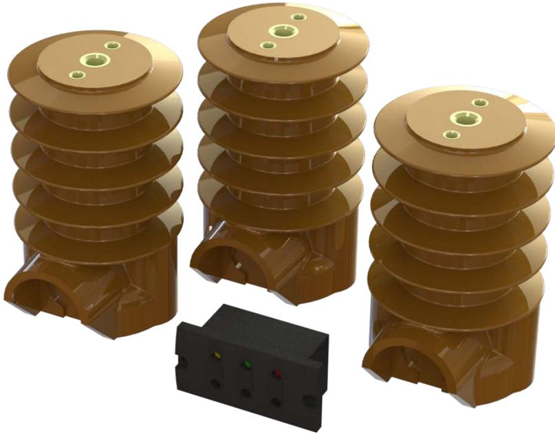
Устройство контроля напряжения (УКН) предназначено для контроля напряжения в диапазоне от 6 до 35 кВ, а также может использоваться для фазировки кабельных присоединений. В комплект поставки входят емкостные датчики напряжения, блок индикаторов напряжения и, при необходимости, устройство фазировки.
